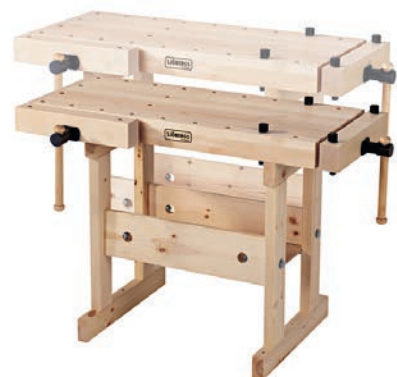
Werkbank höhenverstellbar Platte und Gestell in Buche massiv, geölt, Bankhakenlöcher und 8 Stück Bankhaken sowie einer Vorderzange und einer Hinterzange aus Metall, mit Filzgleiter. Durch Umbau des Untergestells sind zwei unterschiedliche Arbeitshöhen möglich. Breite: 1000 mm Tiefe: 490 mm Höhe: KIGA 640/ HORT 860 mm SP410102
